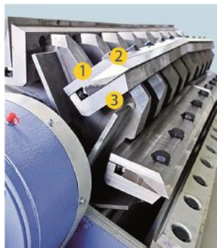
Abb. 4) Rotor Baureihe F mit auswechselbarem Verschleißschutz
