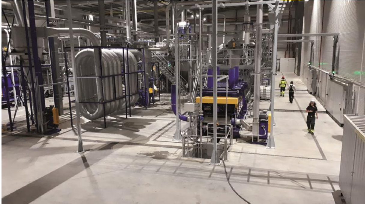
Abb. 5) : Moderne Folienwaschanlage mit Heißwäsche
