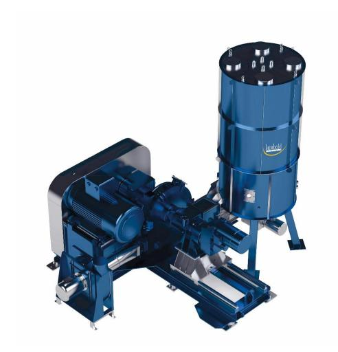
La compactadora de plástico HV 70 es la más potente de la serie de Herbold Meckesheim. Procesa la materia prima en funcionamiento continuo entre un disco compactador rotativo y otro continuo, equipados con barras de prensado atornilladas y de fácil sustitución.
