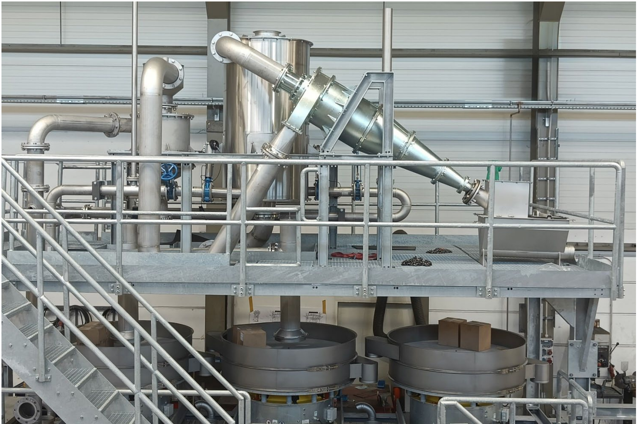
Abbildung 3: Die Hydrozyklonstufe für Doğa ist wie die gesamte PET-Recyclinglinie für eine Leistung von 100 Tonnen am Tag ausgelegt.
