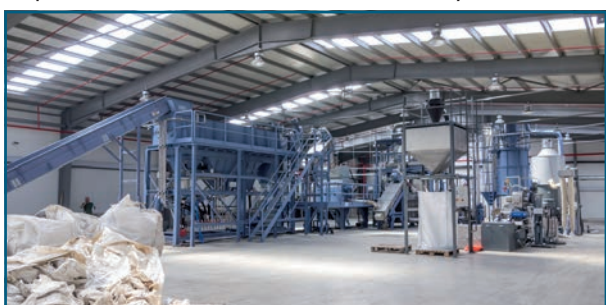
Foto/Fig. 3: Instalación de lavado para folio agrícola en Bulgaria
