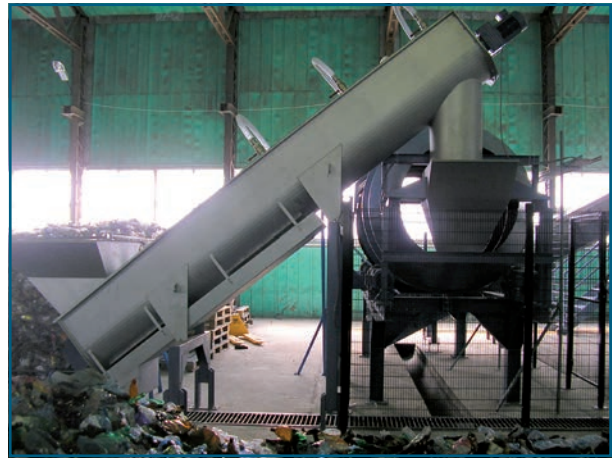
Рис. 4: Барабан предварительной мойки ПЭТ транспортирующим шнеком
