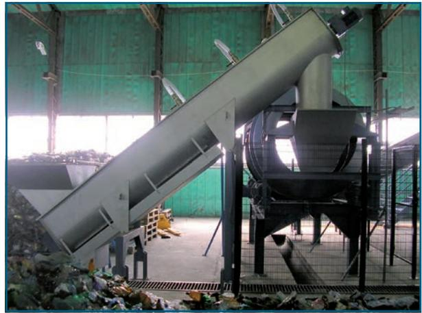
Fig. 4 : Tambour de lavage de PET avec vis de transport en amont
