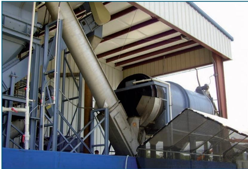
Fig. 5 : Tambour de lavage de films agricoles avec vis de transport
