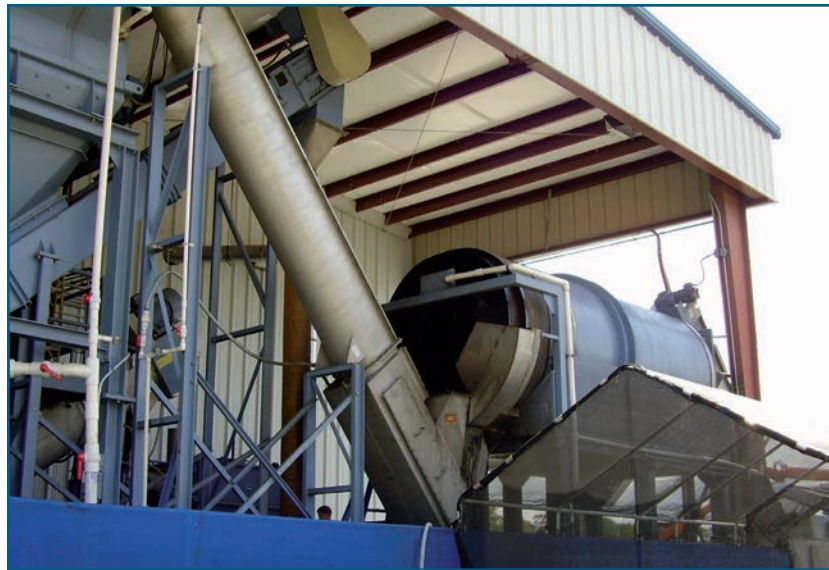
Foto/Fig.5: Tambor de lavado de folio agrícola con sinfín de transporte preconectado
