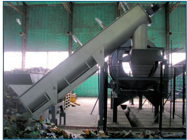
Abb. 4: Waschtrommel PET mit vorgeschalteter Förderschnecke
