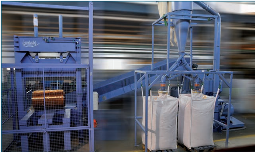
Foto/Fig.3: Combinación de guillotina y molino de corte con tolva depóstio
