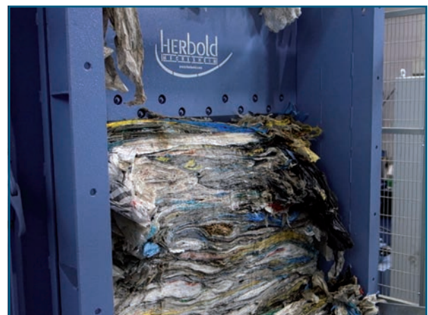
Abb. 2: Zerteilung der unter dem Spaltermesser liegenden Materialportionen
