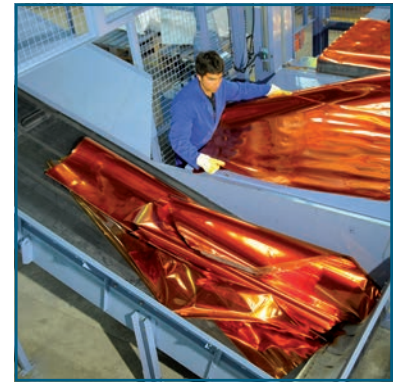
Schritt 3: Materialportionen werden zur Nachzerkleinerung weitergeleitet
