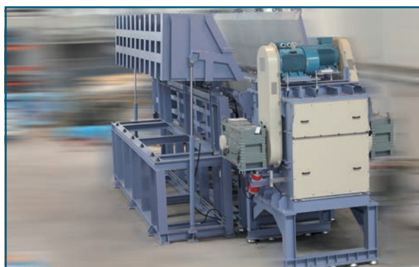
Этап 2: Из накопительной емкости материал выгружается в загрузочный канал
