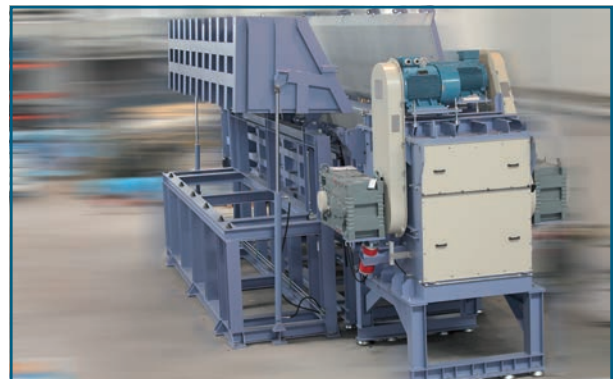
Étape 2 : La benne déverse la matière dans la cuve
