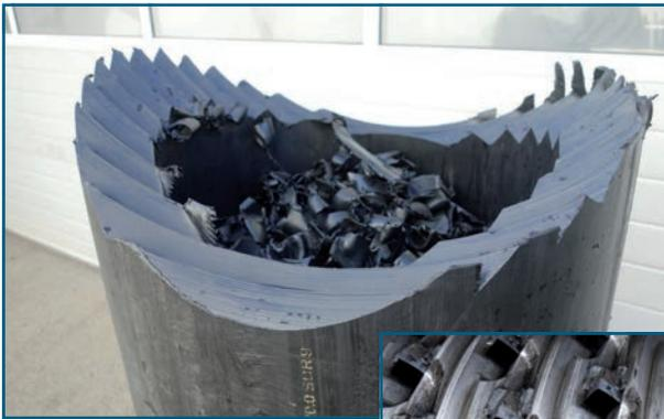
Foto/Fig. 1: Material de alimentación: por ej. Tubos de presión de PE
