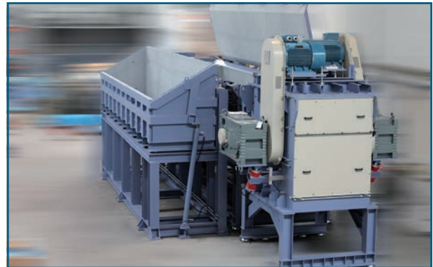
Schritt 1: Aufgabematerial wird der kippbaren Vorratswanne zugeführt
