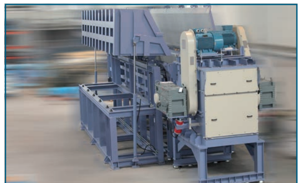
Schritt 2: Vorratswanne „kippt“ das Material in den Trog
