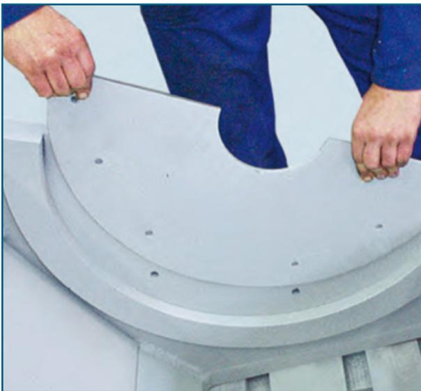
**Fig. 1 :** La chambre de broyage de tous les broyeurs est entièrement protégée par des plaques d'usure échangeables.
