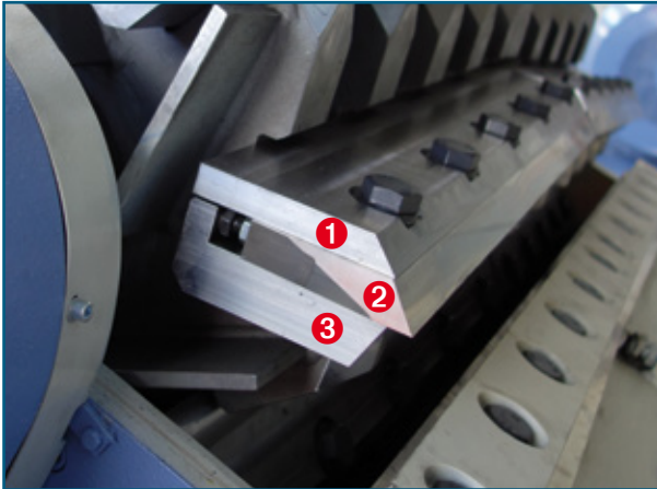
Foto/Fig.3: ❶ Listón de apriete de cuchilla ❷ Cuchillas de rotor ❸ Pieza de desgaste recambiable
