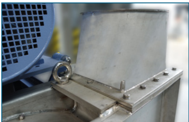
Рис. 6: ... а также сменные всасывающие и напорные патрубки.
