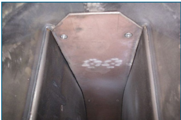
Рис. 5: Воздуховодки содержат сменную противоизносную вставку,
