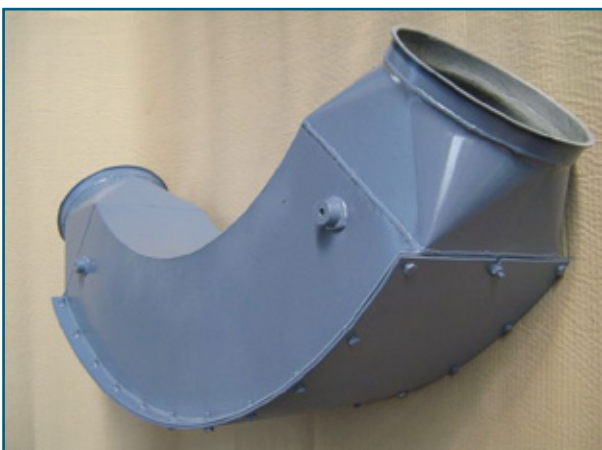
Fig. 2 : Les tubes coudés sont réutilisables grâce à la protection anti-usure échangeable .
