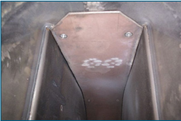
Foto/Fig.5: Los sopladores disponen de una pieza anti-desgaste recambiable ...
