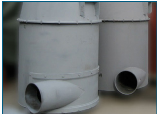
Foto/Fig.4: Separador por ciclón con y sin margen de rebote recambiable.
