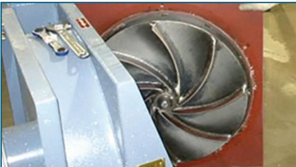
**Abb. 7:** Das Gebläserad hat gekrümmte Schaufeln, welche den Verschleiß verringern und unerwünschte Nachzerkleinerung der Materialien im Gebläse verhindert. Kann auch als EHST Serie aus Hochleistungsstahl geliefert werden.
