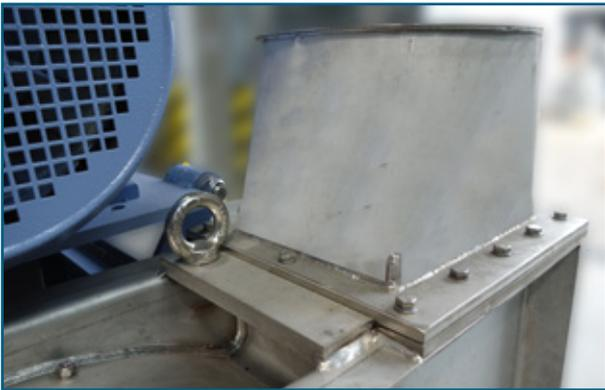
**Abb. 6:** ... sowie über austauschbare Saug- und Druckstutzen.
