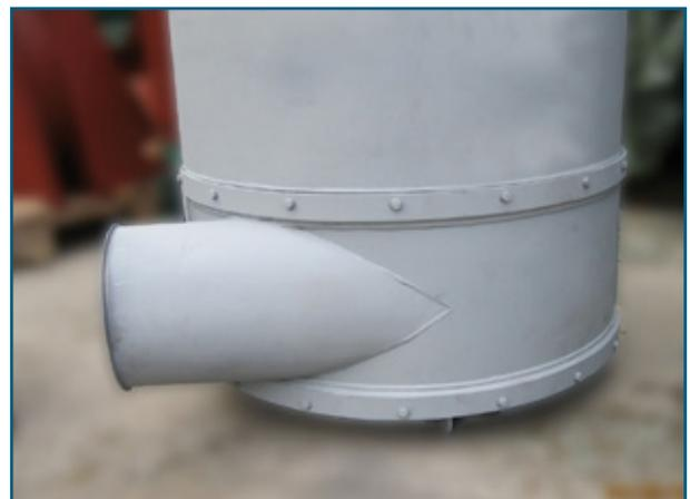
**Abb. 3:** Herbold Zyklonabscheider sind auch mit auswechselbarem Aufprallbereich lieferbar!
