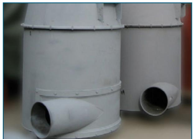
**Abb. 4:** Zyklonabscheider mit und ohne auswechselbaren Aufprallbereich
