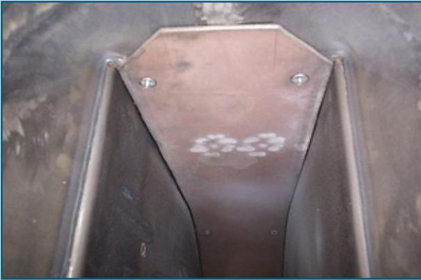
**Abb. 5:** Die Gebläse verfügen über eine austauschbare Verschleißeinlage ...
