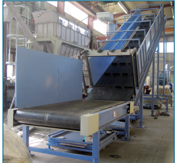
Рис. 1: Конвейер верхнего расположения для целых тюков с лентой для загрузки материала, удаление обвязочной проволоки вручную
