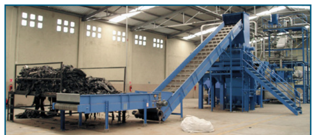
Рис. 3: Конвейер верхнего расположения с сортировочным столом для разделения
