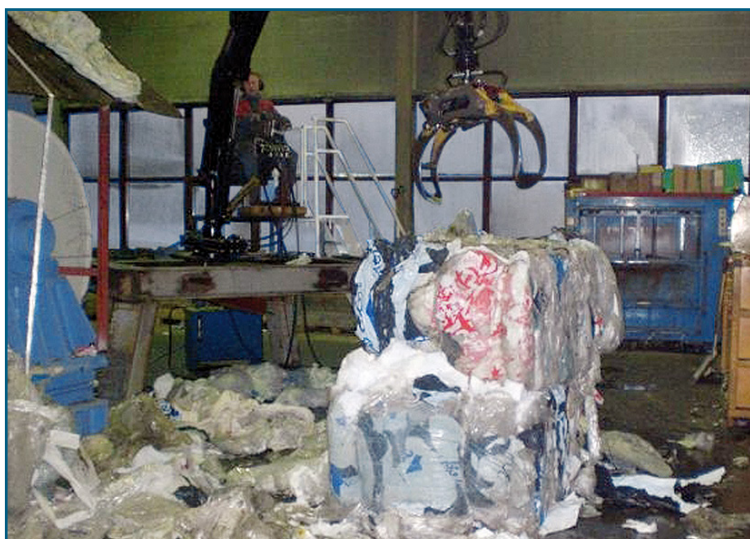
Рис. 4: Прямая загрузка материала в измельчающую машину
