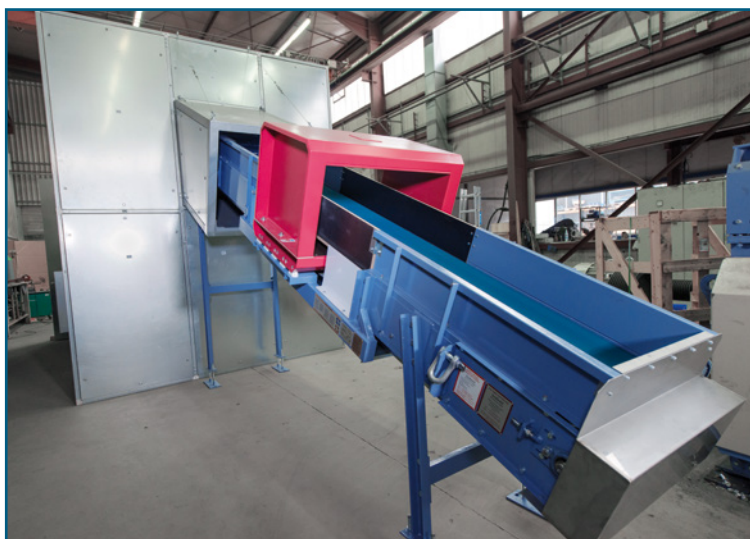
Рис. 5: Ленточный транспортер с металлодетектором и звукоизоляционной кабиной
