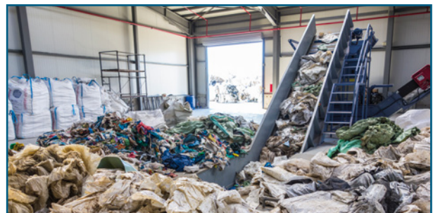
Рис. 2: Конвейер нижнего расположения для загрузки бестарного и разрозненного материала
