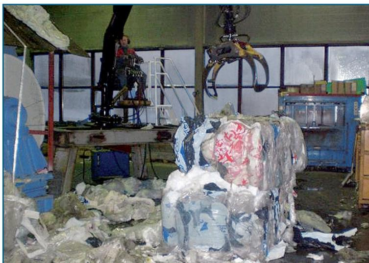
Fig. 4 : Alimentation directe de la machine de recyclage
