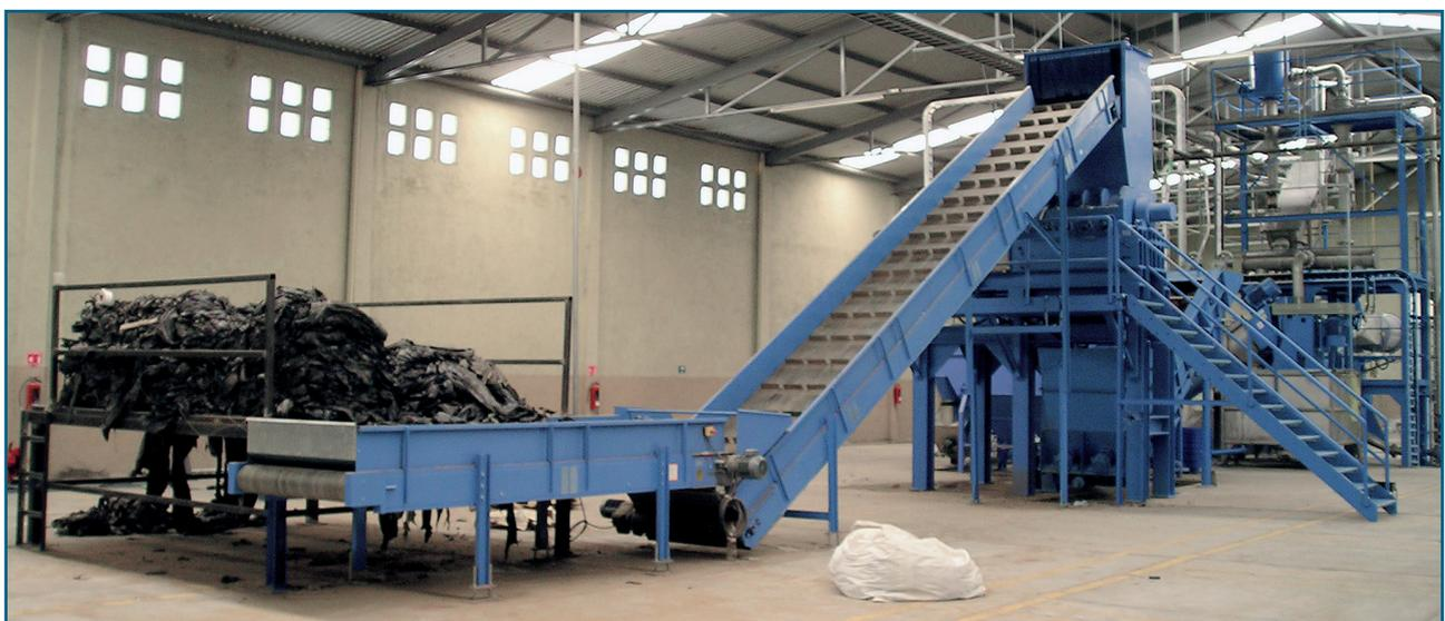
Fig. 3 : Convoyeur à bande surélevé doté d'une table de triage pour les opérations de séparation
