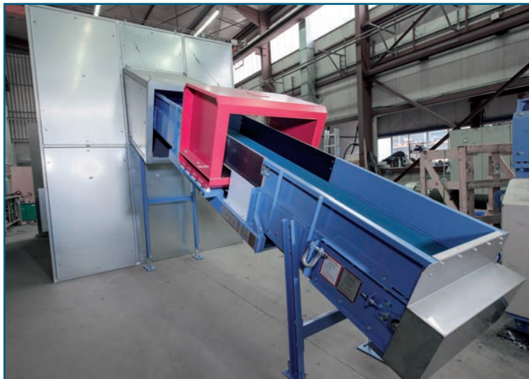
Foto 5: Cinta de transporte con detector de metales y cabina de insonorización
