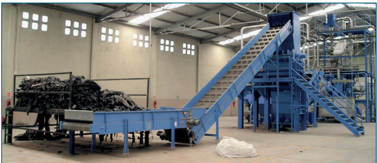
Foto 3: Cinta de transporte superior con mesa de clasificación para separar
