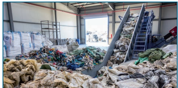
Foto 2: Cinta de transporte inferior para la alimentación de material suelto separado
