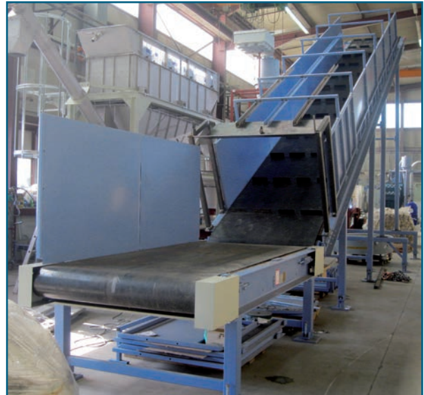
Foto 1: Cinta de transporte superior para balas enteras con cinta de alimentación de material, retirada manual de flejes de alambre
