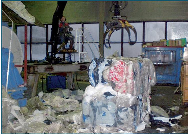
**Abb. 4:** Direktaufgabe in die Zerkleinerungsmaschine
