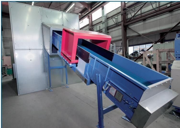
**Abb. 5:** Förderband mit Metalldetektor und Schallschutzkabine
