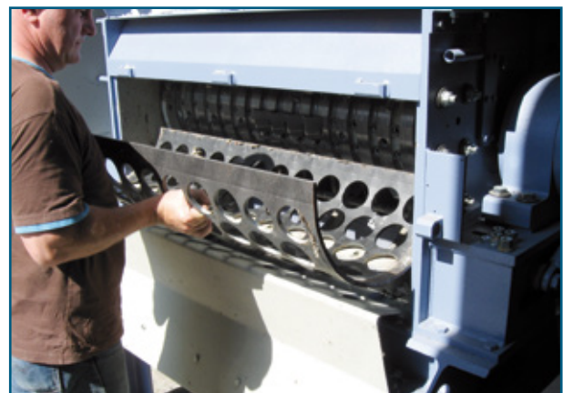
Рис. 5: Сетчатый короб, откидываемый с помощью гидравлики, удобная замена сит
