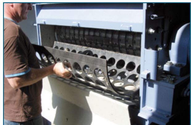
Fig. 5: Support de grille à commande hydraulique, remplacement aisé et rapide de la grille
