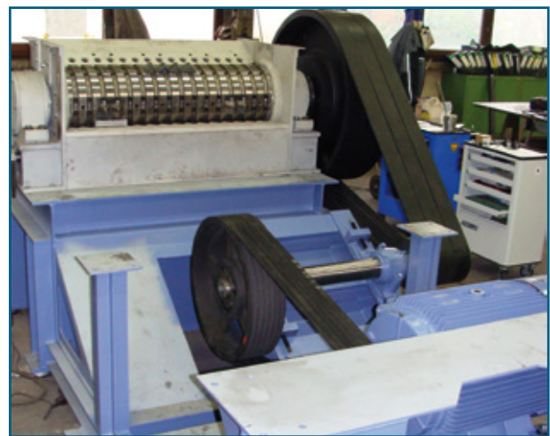
Fig. 4: Entraînement par courroies trapézoïdales et arbre intermédiaire
