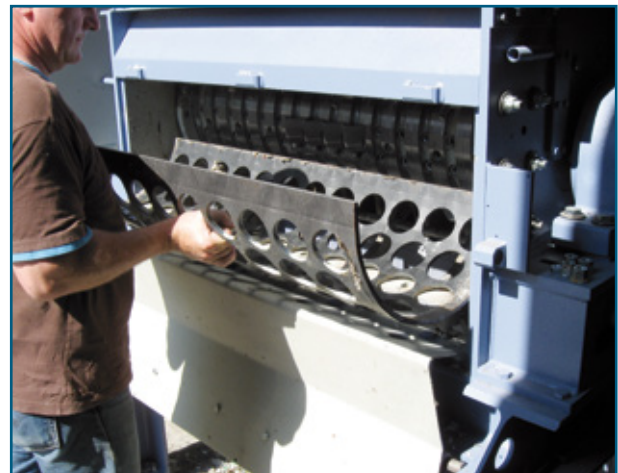
Fig. 5: Cesta de criba separable de forma hidráulica, cambio de criba rápido y cómodo
