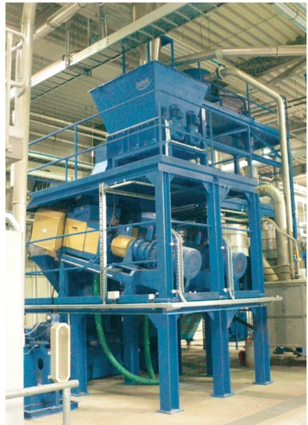
Deux vis EPS 75 munies d'un réservoir de distribution
