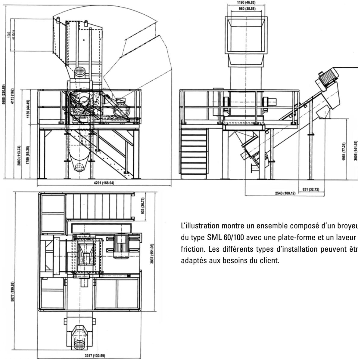
L'illustration montre un ensemble composé d'un broyeur du type SML 60/100 avec une plate-forme et un laveur à friction. Les différents types d'installation peuvent être adaptés aux besoins du client.
