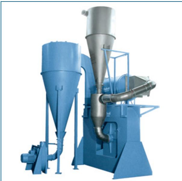
Поток материала вместе с горячим воздухом всасывается пневмотранспортером. После чего, смесь попадает в турбулентный канал сушилки, который имеет форму 30-метровой спирали. Это необходимо для отделения остаточной влажности от материала. На этом участке для постоянного контроля температуры установлен температурный датчик. При применении электронагревательных элементов, фактическая температура сравнивается с заданной и по необходимости
