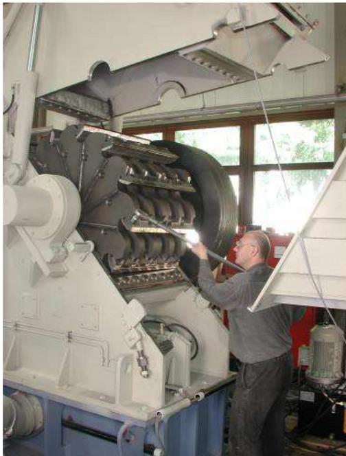
Montage des couteaux rotor à l'aide d'une clé dynamométrique sur un broyeur HERBOLD, modèle SMR 80/120 pour tubes
