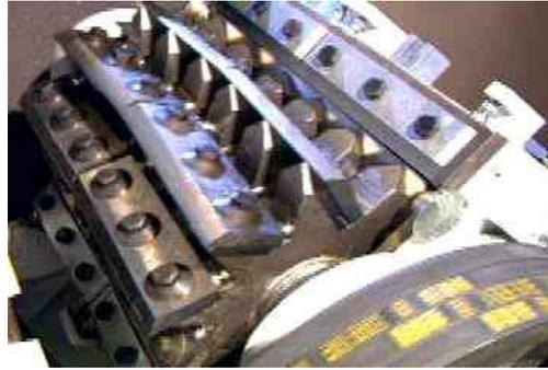
Couteaux rotor et vis de fixation sur un broyeur HERBOLD pour profilés de la série SMP.
