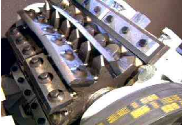
Rotormesser einer HERBOLD-Profileschneidmühle, Baureihe SMP
