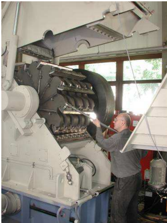
Rotormesserbefestigung mit Drehmomentschlüssel an einer HERBOLD-Rohrschneidmühle, Typ SMR 80/120
