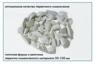
Только из крупной стружки при последующей переработке путем дробления получается хорошо сыпучий материал с большим насыпным весом.
