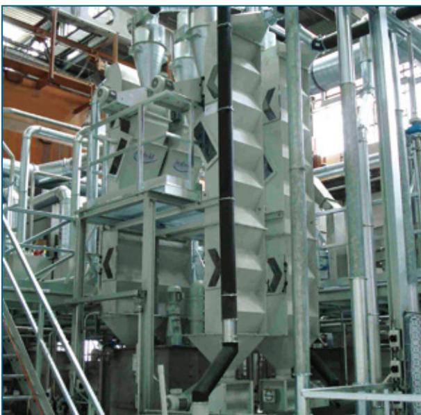
Fig. 1: Séparateur gravimétrique HERBOLD faisant partie d'une installation de lavage pour bouteilles PET
