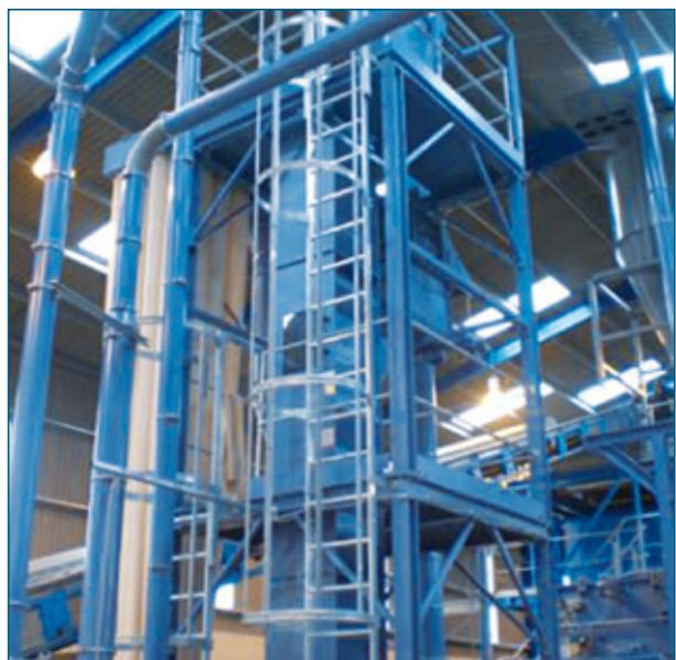
Fig. 2: Séparateur gravimétrique avec plateforme de maintenance
