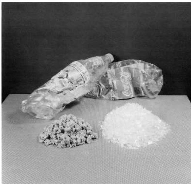
Was die Aufbereitung dieser Art von Kunststoffabfällen bisher erschwerte, waren die fest haftenden Etiketten auf dem ansonsten sauberen Material. Trockenverfahren mit Windsichtern versagten. Schmelzfilter spezieller Bauart erwiesen sich als zu aufwendig. So sah man sich gezwungen, die Etiketten aus dem Ausschußmaterial herauszuschneiden, - vom Materialverlust einmal ganz abgesehen - ein enorm zeitaufwendiges und teures Verfahren.
