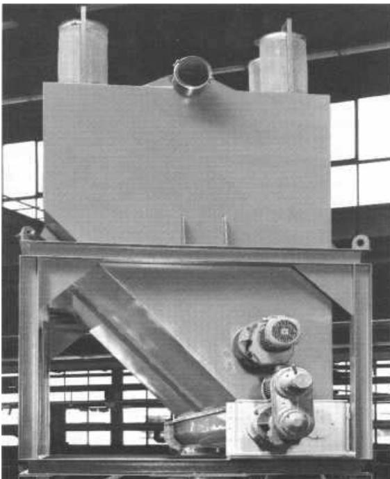
Von konventionellen Rundsilos unterscheiden sie sich vor allem durch ihre liegende Bauweise mit unten angebrachten, horizontal angeordneten Einzel- oder Doppelaustrageschnecken. Drei Wände sind vertikal angeordnet, die vierte Wand befindet sich in Schräglage und ist mit Auflockerungseinrichtungen versehen.
