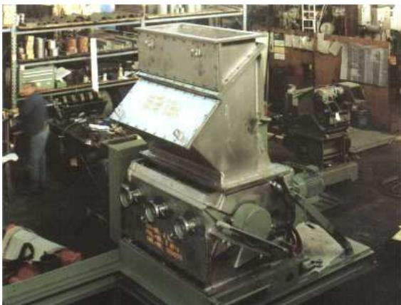
Broyeur modèle SMS 45/120 - fermé
