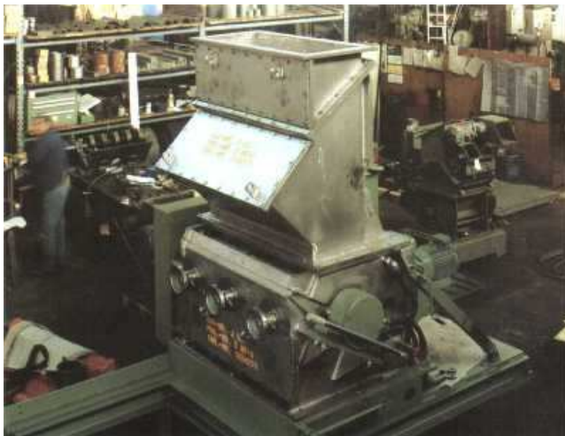
Schneidmühle Typ SMS 45/120 - geschlossen
