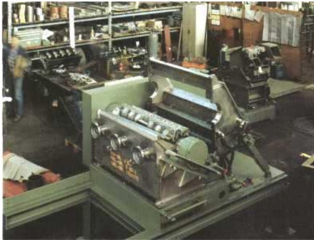
Schneidmühle Typ SMS 45/120 - geöffnet
