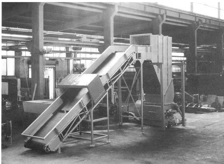
photo 1: tapis convoyeur avec détecteur de métaux
