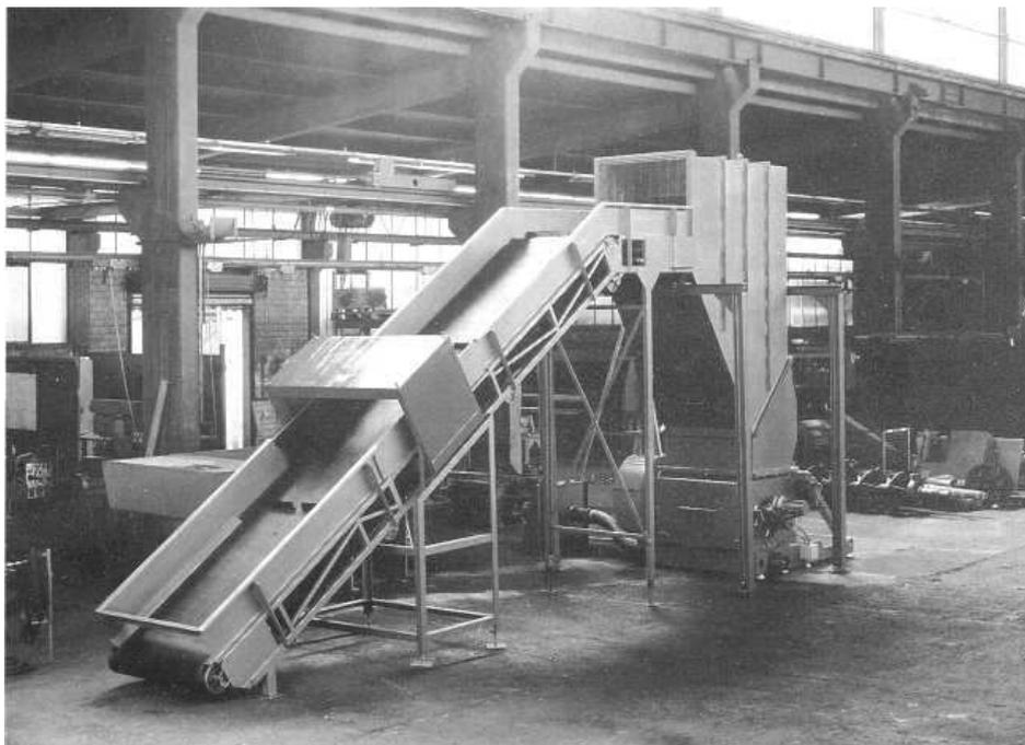
Bild 1: Förderband mit Metallsuchbrücke
