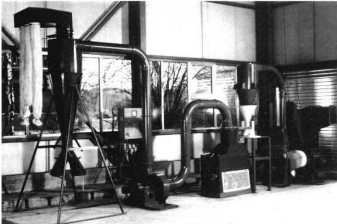
Bild 4: Sichter mit Pufferbehälter und vorgeschalteter Schneidmühle
