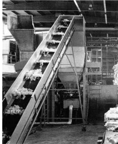
Bild 6: Schneidmühle mit vorgeschaltetem Schwimm-Sink-Becken
