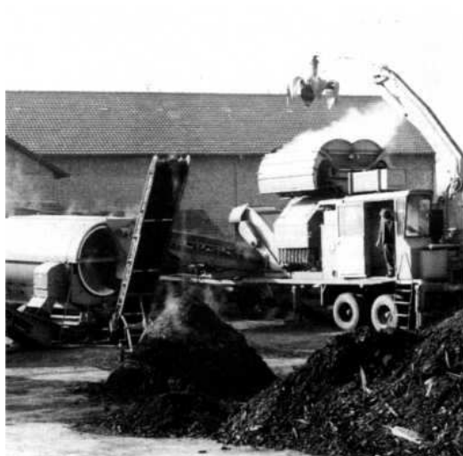
Mobile Ausführung für Rindenkompostierung.
