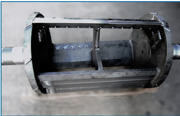
Рис.1: Гильотинный ротор без сплошного вала, со скребками между корпусом дробилки и внешним диском ротора.
