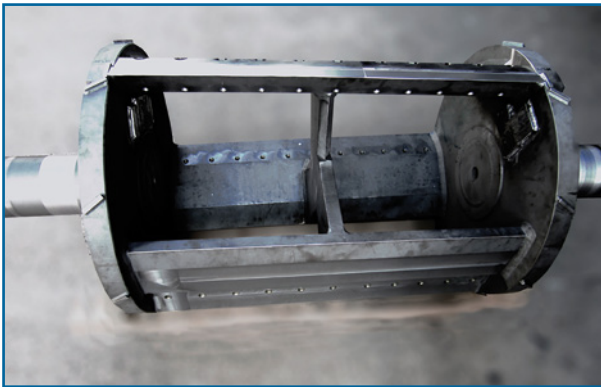
Fig. 1 : Rotor-guillotine sans axe traversant avec racleurs entre la paroi du carter et le disque extérieur du rotor.
