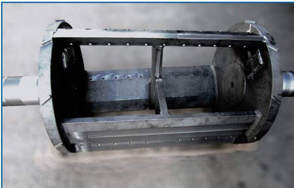
Fig 1: Rotor de guillotina sin eje de rotor atravesado, con raspadores entre la pared de la carcasa y el disco de rotor exterior.
