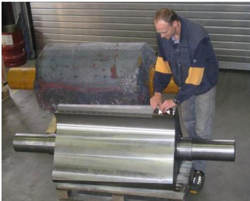
HERBOLD rüstet Schneidmühlen optional mit dem Schneidrotor der Bauform "A" aus, dessen Bauweise inzwischen konstruktiv überarbeitet und nochmals verbessert wurde.
