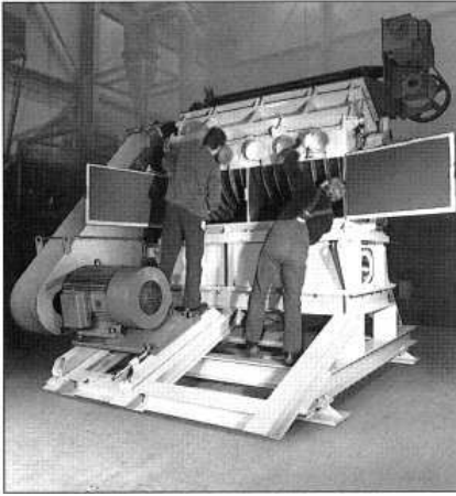
Mühle in geöffnetem Zustand
