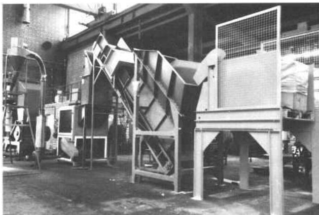
Nous proposons également des accessoires aux broyeurs centraux comme par exemple un système d'alimentation automatique consistant en un dispositif d'alimentation à bascule pour casier et une bande convoyeuse à dosage avec détecteur de métaux ainsi que, placé en aval du broyeur, un cyclone séparateur pour la séparation de fines, un filtre pour air de sortie et séparateurs de métaux.
