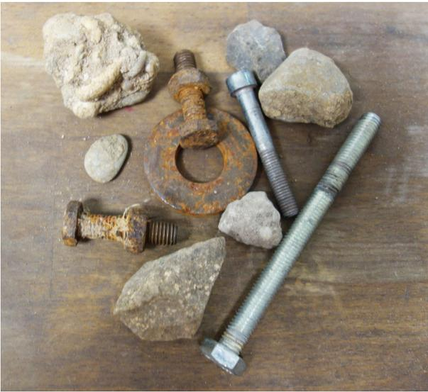
**Abb.1:** Beispiel für abgetrennte Fremdkörper und Störstoffe aus Gutmaterial PET Flaschen in einer Recyclinganlage.
