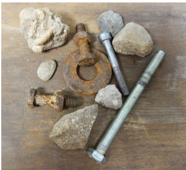
Fig. 1: Exemple de corps étrangers et d'impuretés issus de bouteilles de PET après traitement dans une ligne de recyclage.
