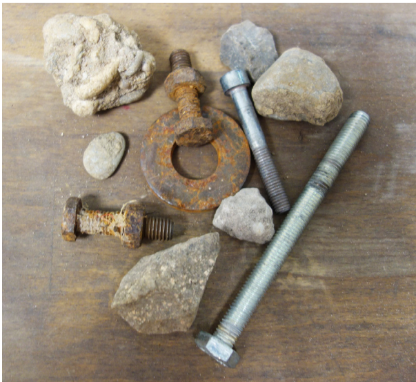
Fig.1: Ejemplo de separación de cuerpos extraños e impurezas de botellas de PET de buen material en una planta de reciclaje.
