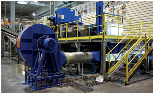
Fig.2: Ventilador del inyector, tubo de salida ascendente con conducto de descarga y ciclón para la descarga de material en un separador balístico.
